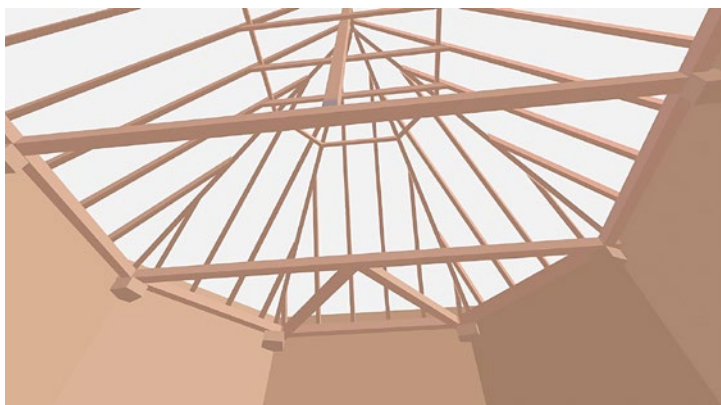
Model středověkého krovu s využitím vnitřních konzol kostela sv. Kateřiny
